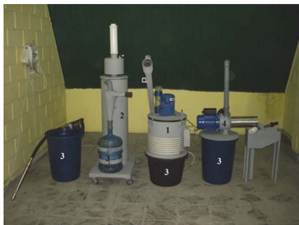
Рис. 1. Общий вид ТМК «Экотром-2У». 1 – аппарат измельчения ЛЛ и нейтрализации ртути; 2 – узел очистки технологического воздуха; 3 – сборники-накопители сырья; 4 – измельчитель КЛЛ
