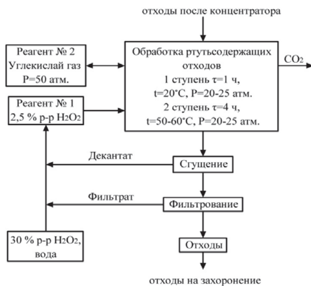
Рис. 1. Технологическая схема переработки твердых ртутьсодержащих отходов.
