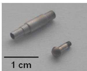
Рис. 1. Катод и анод с Pt покрытием
