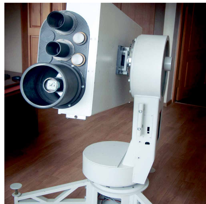
Аэрозольно-рамановский сканирующий поляризационный лидар ЛОЗА-М3
