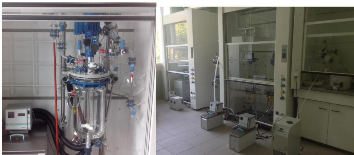
Рисунок 10 – Оборудование для синтеза соединений в укрупненных масштабах
