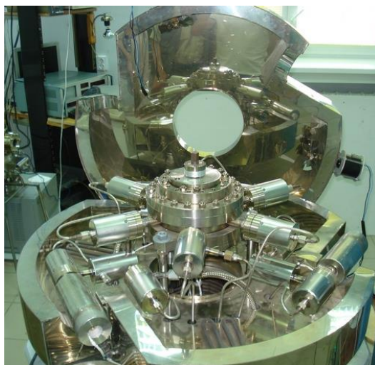
Рисунок 12– Импульсный MOCVD реактор
