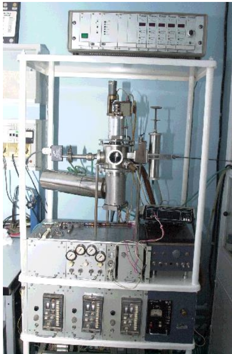
Рисунок 11 – Проточный MOCVD реактор
