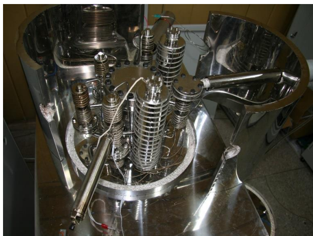
Рисунок 14 – Импульсный MOCVD реактор с четырьмя источниками
