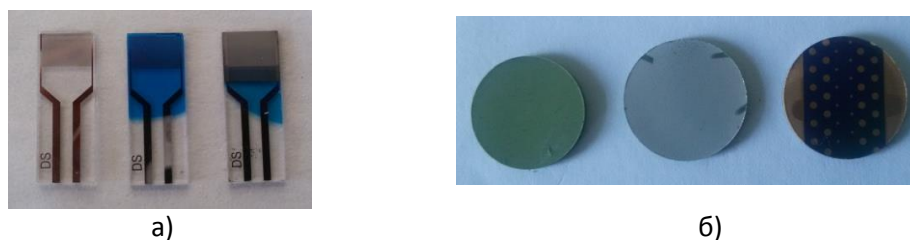
Рисунок 16 – а) гибридные пленочные структуры типа (1) и (2); б) – гетероструктура (2): слева - керамическая подложка YSZr, посередине - керамическая подложка с осажденным слоем Pd, справа – с пленкой фталоцианина с осажденными контактами из Au
