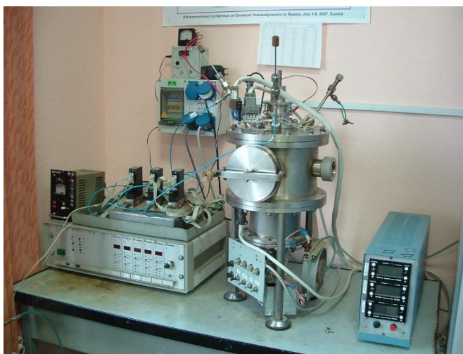
Рисунок 12 – УФ-стимулированный MOCVD реактор
