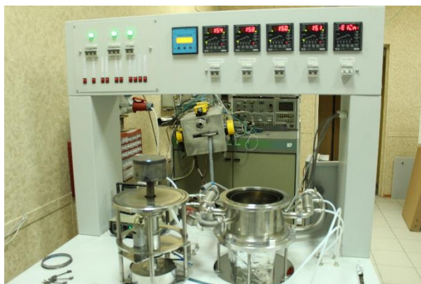
Рисунок 13 – проточный MOCVD реактор с покрываемой площадью до 100 \text{ мм}^2
