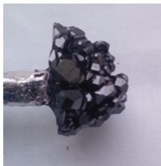
Рис. 2. Друза кристаллов  $Tb_2O_3$ , выращенная из раствора-расплава.
