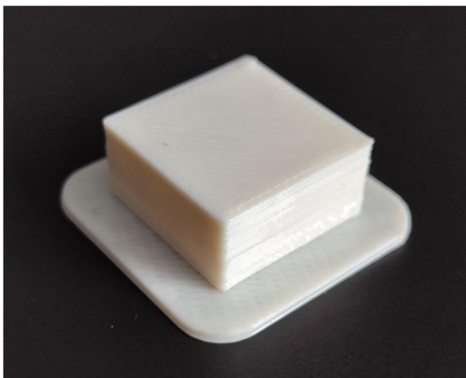
Рис. 1. Фотография образца хитозан – полилактид – поликапролактон состава 1:1:1 (по массе), напечатанного методом FDM.
