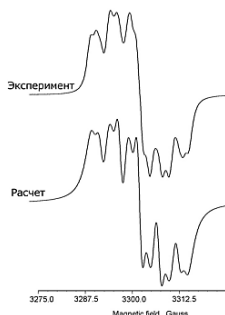
Рис. 11. Спектр ЭПР раствора восстановленного 6 в ТГФ при 300K с параметрами g=2,0033 , A(\text{N}) = 5,1 Гс от двух атомов азота и A(\text{H}) = 2 Гс от двух атомов водорода (а)
