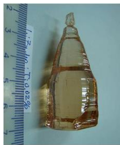
Рис. 5. Кристалл LZM: Ti^{4+} (0.02 мол. %), выращенный из раствора-расплава Li_2Zn_2(MoO_4)_3 – Li_2MoO_4 по [010]
