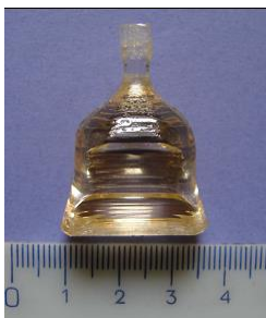
Рис. 11. Кристалл LMM, выращенный из раствора-расплава \text{Li}_2\text{Mg}_2(\text{MoO}_4)_3\text{--Li}_2\text{MoO}_4 (67 мол. %) по [010]
