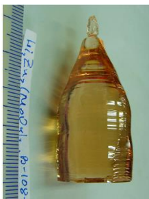
Рис. 4. Кристалл LZM, выращенный из раствора-расплава Li_2Zn_2(MoO_4)_3 – Li_2MoO_4 (5 мол. %) по [100]
