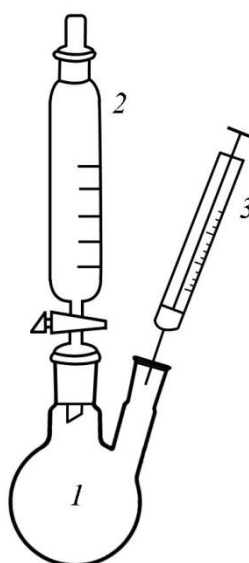
Рис. 20. Аппарат для разложения сульфидов РЗЭ: 1 – реакторная колба, 2 – делительная воронка, 3 – микрошприц.
