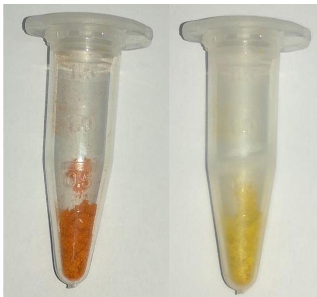
Рис. 43. Образец E1 при комнатной температуре (слева) и непосредственно после выдерживания в жидком азоте (справа)
