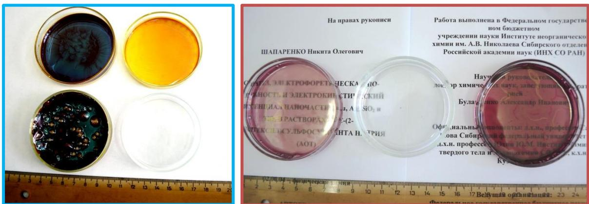
**Рис. 90.** Композитные пленки наночастиц серебра (слева) и золота (справа) с различной концентрацией в полистироле (в том числе и вспененном – слева внизу), высушенных в чашках Петри.
