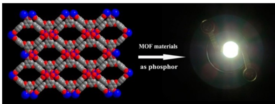
Рис. 24. Структура MOF и белая светодиодная лампа, покрытая порошком \text{La}_{0.6}\text{Eu}_{0.1}\text{Tb}_{0.3}\text{-MOF} [120].
