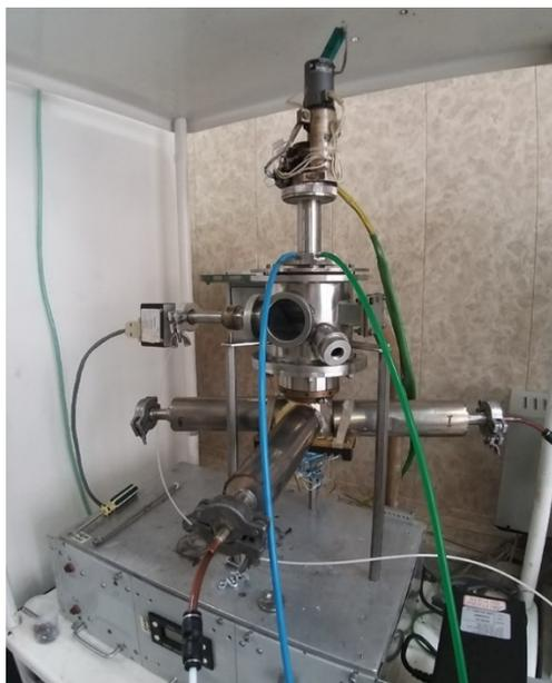
Рисунок 3.14. Реактор проточного типа низкого давления LP-MOCVD.
