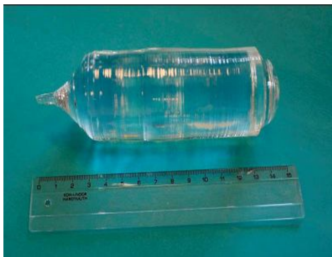
Рис. 3. Кристаллы \text{Li}_2\text{MoO}_4 , выращенные методом LTG Cz
