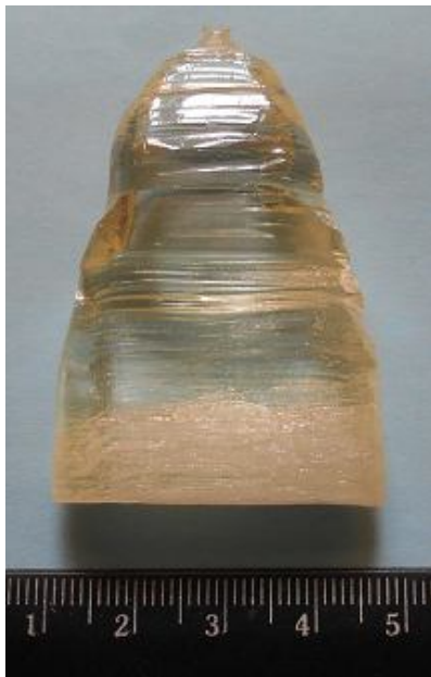
Рис. 55. Кристалл LMM, выращенный из раствора-расплава \text{Li}_2\text{Mg}_2(\text{MoO}_4)_3\text{-Li}_2\text{MoO}_4 (60 мол. %) по направлению [010]
