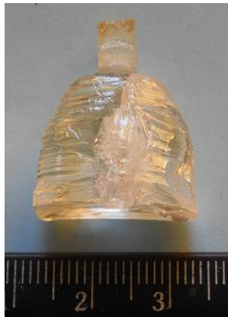
Рис. 54. Кристалл LMM, выращенный из раствора-расплава \text{Li}_2\text{Mg}_2(\text{MoO}_4)_3\text{-Li}_2\text{MoO}_4 (60 мол. %) по направлению [100]
