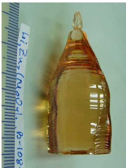
Рис. 25. Кристалл LZM, выращенный из раствора-расплава \text{Li}_2\text{Zn}_2(\text{MoO}_4)_3\text{-Li}_2\text{MoO}_4 (5 мол. %) по направлению [100].
