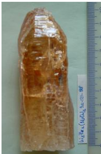
Рис. 31. Кристалл LZM, выращенный из раствора-расплава \text{Li}_2\text{Zn}_2(\text{MoO}_4)_3\text{-Li}_2\text{O}\cdot 2\text{MoO}_3 (10 мол. %) по [010]
