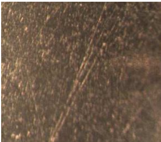
Рис. 76. Поверхность кристалл LMM после травления 20 %-ным раствором кислоты \text{HNO}_3 : плоскость (100), увеличение 40х
