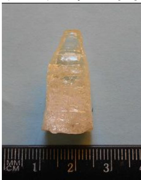
Рис. 51. Кристалл LMM, выращенный из раствора-расплава \text{Li}_2\text{Mg}_2(\text{MoO}_4)_3\text{-Li}_2\text{MoO}_4 (67 мол. %) по направлению [010]
