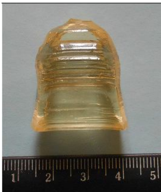
Рис. 53. Кристалл LMM, выращенный из раствора-расплава \text{Li}_2\text{Mg}_2(\text{MoO}_4)_3\text{-Li}_2\text{MoO}_4 (67 мол. %) по направлению [001]
