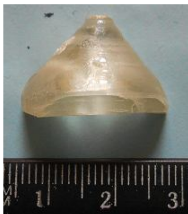
Рис. 65. Кристалл LMM: \text{Ti}^{4+} (1 ат. %), выращенный из раствора-расплава \text{Li}_2\text{Mg}_2(\text{MoO}_4)_3\text{-Li}_2\text{MoO}_4 по [010]
