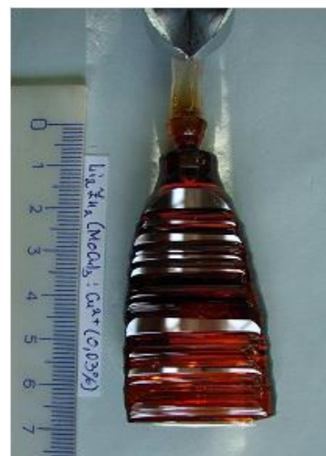
Рис. 36. Кристалл LzM:Cu 2+ (0.03 мол. %), выращенный из раствора-расплава \text{Li}_2\text{Zn}_2(\text{MoO}_4)_3 – \text{Li}_2\text{MoO}_4 по [010]
