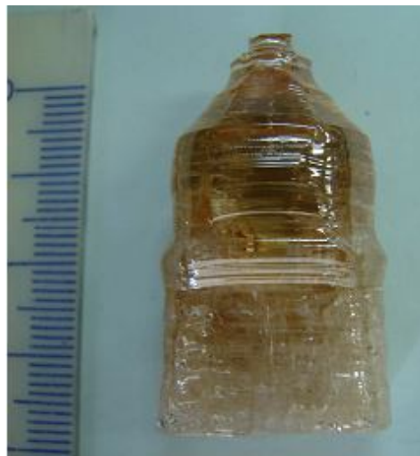
Рис. 32. Кристалл LZM, выращенный из раствора-расплава \text{Li}_2\text{Zn}_2(\text{MoO}_4)_3\text{-Li}_2\text{O}\cdot 3\text{MoO}_3 (10 мол. %) по [010]
