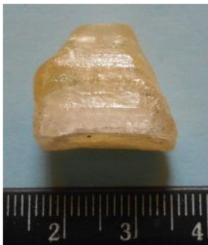
Рис. 59. Кристалл LMM, выращенный из раствора-расплава \text{Li}_2\text{Mg}_2(\text{MoO}_4)_3\text{-Li}_2\text{O}\cdot 2\text{MoO}_3 (67 мол. %) по направлению [010], скорость вытягивания 2 мм/сут
