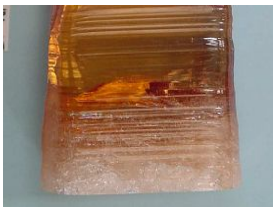
Рис. 28. Включения в нижней части кристалла LZM
