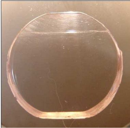
Рис. 29. Поперечный срез кристалла LZM, выращенного из раствора-расплава \text{Li}_2\text{Zn}_2(\text{MoO}_4)_3\text{-MoO}_3 (5 мол. %) по направлению [010]
