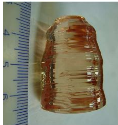
Рис. 40. Кристалл LZM:Ti 4+ (0.2 мол. %), выращенный из раствора-расплава Li 2 Zn 2 (MoO 4 ) 3 -Li 2 MoO 4 по [010]
