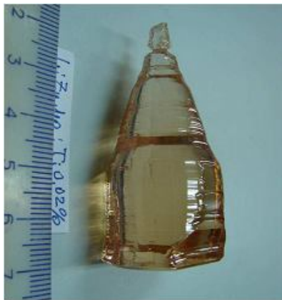
Рис. 39. Кристалл LZM:Ti 4+ (0.02 мол. %), выращенный из раствора-расплава Li 2 Zn 2 (MoO 4 ) 3 -Li 2 MoO 4 по [010]
