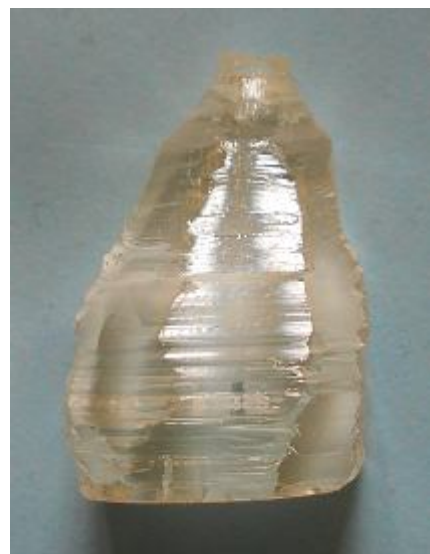
Рис. 67. Грани на поверхности кристалла LMM, выращенного по направлению [010]
