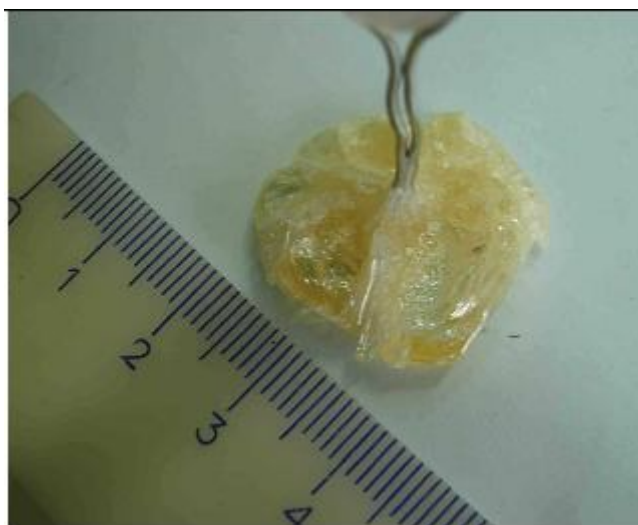
Рис. 45. Кристалл LMM, выращенный на платиновую проволоку из раствора-расплава \text{Li}_2\text{Mg}_2(\text{MoO}_4)_3\text{-Li}_2\text{MoO}_4 (67 мол. %)
