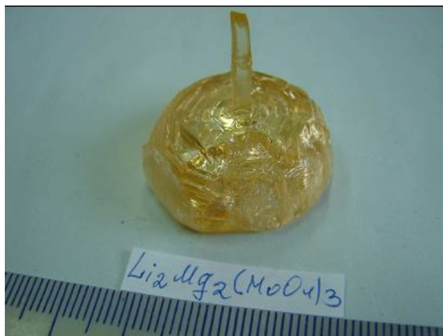
Рис. 47. Кристалл LMM, выращенный из раствора-расплава \text{Li}_2\text{Mg}_2(\text{MoO}_4)_3\text{-Li}_2\text{MoO}_4 (67 мол. %) на затравку по [100]
