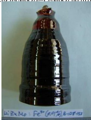
Рис. 37. Кристалл LzM:Fe 3+ (0.01 мол. %), выращенный из раствора-расплава \text{Li}_2\text{Zn}_2(\text{MoO}_4)_3 – \text{Li}_2\text{MoO}_4 по [010]
