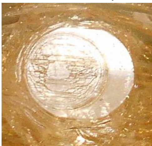
Рис. 61. Участок фронта роста кристалла LMM, образованного гранью (010)
