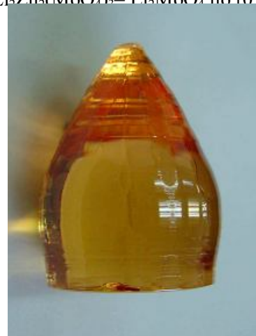
Рис. 36. Кристалл LzM:Cu 2+ (0.03 мол. %), выращенный из раствора-расплава \text{Li}_2\text{Zn}_2(\text{MoO}_4)_3 – \text{Li}_2\text{MoO}_4 по [010]
