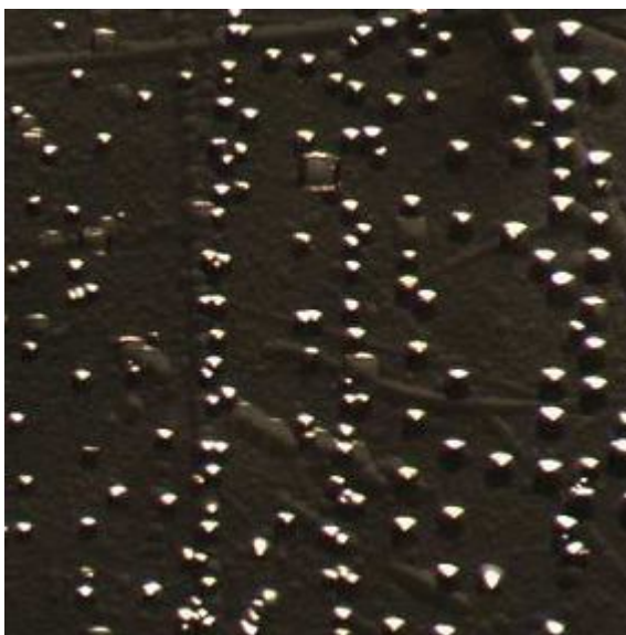
Рис. 72. Поверхность кристалл LZM после травления 20 %-ным раствором кислоты \text{HCl} : плоскость (100), увеличение 40x
