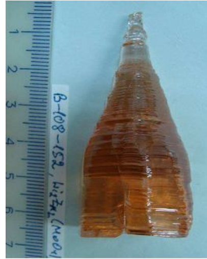
Рис. 30. Кристалл LZM, выращенный из раствора-расплава \text{Li}_2\text{Zn}_2(\text{MoO}_4)_3\text{-MoO}_3 (15 мол. %) по [010]
