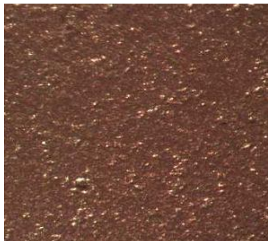
Рис. 68. Поверхность кристалл LZM после травления 20 %-ным раствором кислоты HNO 3 : плоскость (100), увеличение 40х
