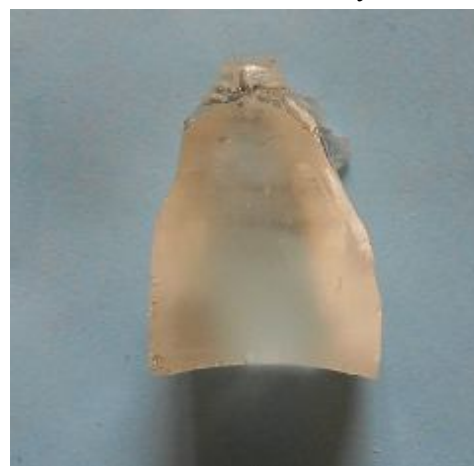
Рис. 62. Продольный срез кристалла LMM, выращенного из раствора-расплава \text{Li}_2\text{Mg}_2(\text{MoO}_4)_3\text{-Li}_2\text{MoO}_4
