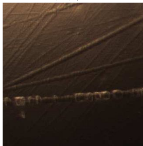
Рис. 79. Поверхность кристалл LMM после травления смесью растворов кислот \text{HNO}_3 и \text{H}_3\text{PO}_4 : плоскость (100), увеличение 70х
