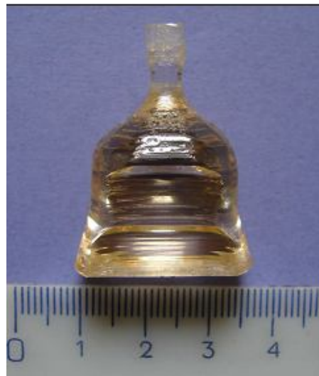
Рис. 50. Кристалл LMM, выращенный из раствора-расплава \text{Li}_2\text{Mg}_2(\text{MoO}_4)_3\text{-Li}_2\text{MoO}_4 (67 мол. %) по направлению [010]
