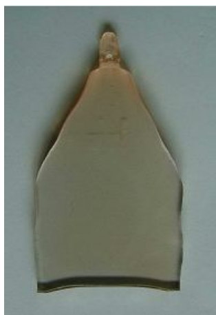
Рис. 33. Продольный срез кристалла LZM, выращенного из раствора-расплава \text{Li}_2\text{Zn}_2(\text{MoO}_4)_3\text{-Li}_2\text{MoO}_4
