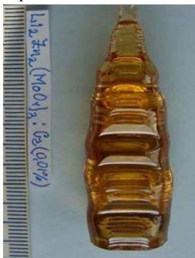
Рис. 35. Кристалл LzM:Cr 3+ (0.1 мол. %), выращенный из раствора-расплава \text{Li}_2\text{Zn}_2(\text{MoO}_4)_3 – \text{Li}_2\text{MoO}_4 по [010]
