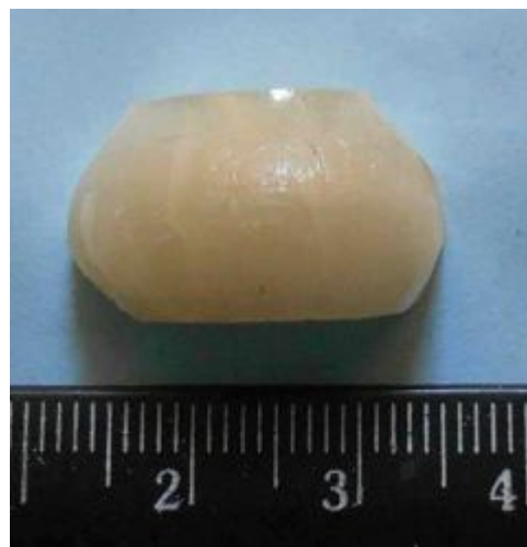
Рис. 60. Кристалл LMM, выращенный из раствора-расплава \text{Li}_2\text{Mg}_2(\text{MoO}_4)_3\text{-Li}_2\text{O}\cdot 2\text{MoO}_3 (67 мол. %) по направлению [010], скорость вытягивания 1 мм/сут
