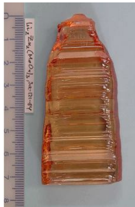
Рис. 26. Кристалл LZM, выращенный из раствора-расплава \text{Li}_2\text{Zn}_2(\text{MoO}_4)_3\text{-Li}_2\text{MoO}_4 (15 мол. %) по [010].
