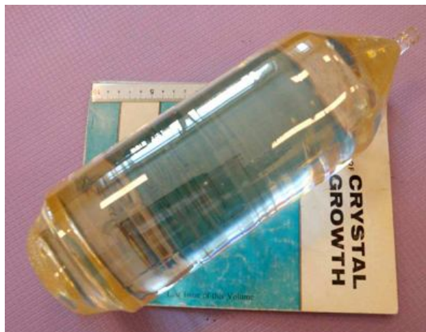
Рис. 5. Кристаллы \text{CdWO}_4 , выращенные методом LTG Cz
