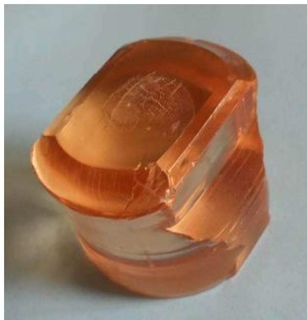
Рис. 41. Грани на поверхности кристалла LZM, выращенного по направлению [010].
