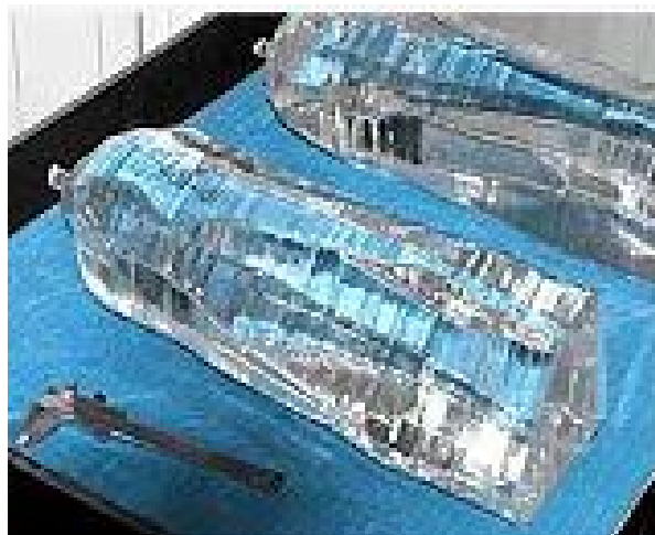
Рис. 6. Кристаллы \text{Bi}_4\text{Ge}_3\text{O}_{12} , выращенные методом LTG Cz
