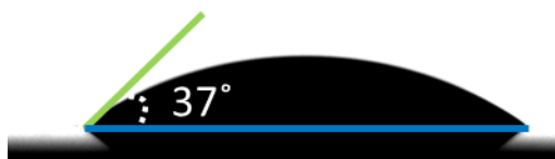
Рис. 1. Типичное изображение лежащей капли на поверхности плёнки \text{SiC}_x\text{N}_y
