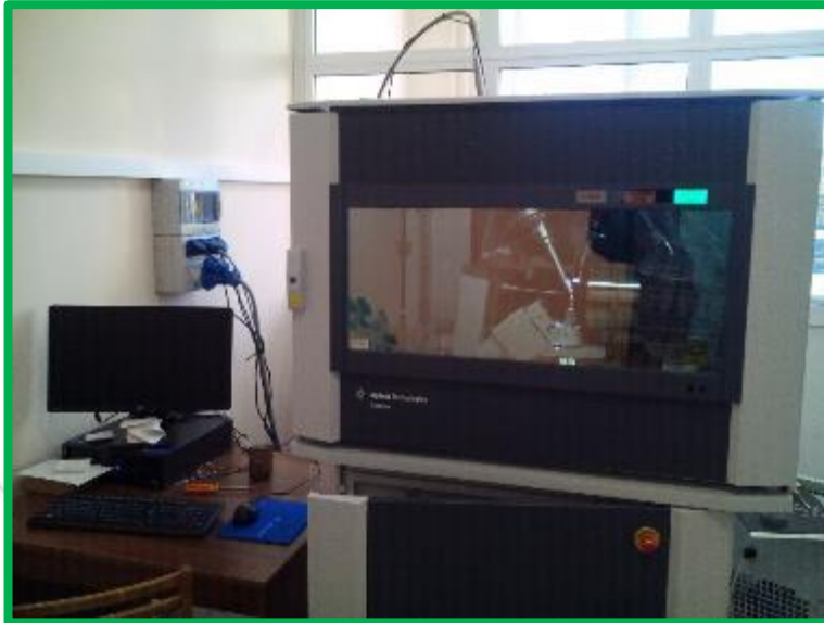
Монокристалльный дифрактометр Agilent Technologies Xcalibur
