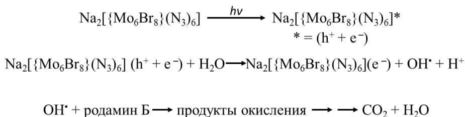
Рис. 8. Схема взаимодействия кластерного комплекса с родамином Б
