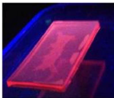
Рис. 24. Образец модифицированного полиуретана под ультрафиолетовым облучением
