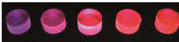
Рис. 21. Фотографии таблетированных образцов (\text{Bu}_4\text{N})_2[\{\text{Mo}_6\text{Br}_8\}\text{F}_6] @ПММА, с массовой концентрацией кластерного комплекса до 0.36 под ультрафиолетовым облучением
