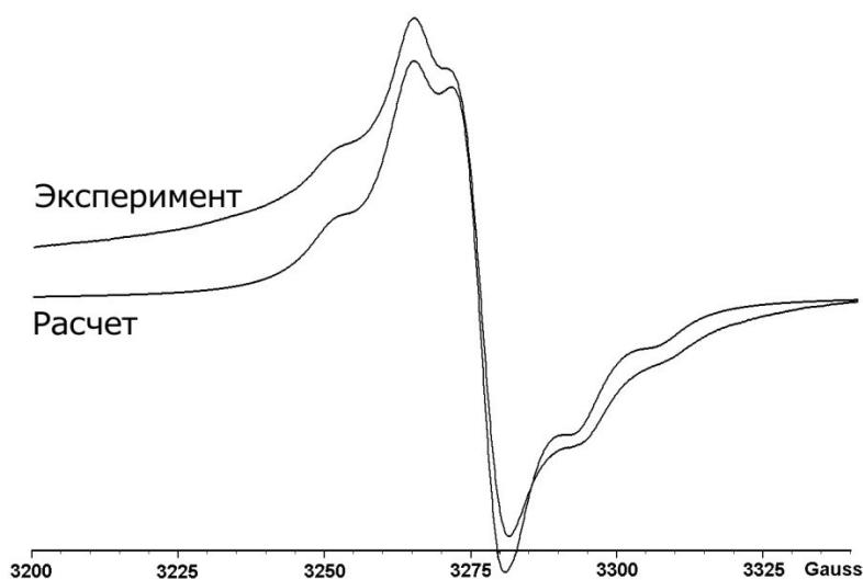
Рис. 50. Спектр ЭПР твердого образца восстановленного [\text{Co}(\text{Ph}\text{аспсбtd})_2] в X диапазоне частот при 300 К с параметрами g_{\parallel} = 2,0025 , g_{\perp} = 2,0052 ; СТС от двух атомов азота с A_{\parallel}(\text{N}) = 13,8 Гс, A_{\perp}(\text{N}) = 0,75 Гс
