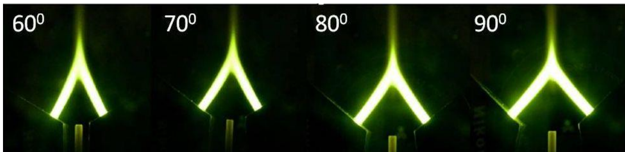
Рис. 9. Вид плазменного факела ДДП при углах между струями 60-90°
