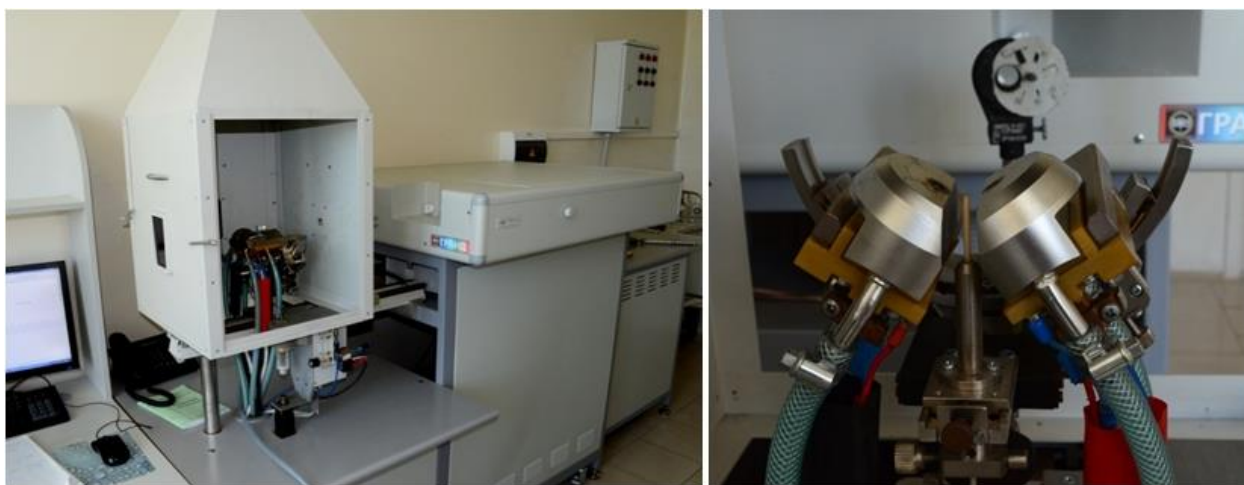
Рис. 1. Двухструйный дуговой плазмотрон «Факел»
