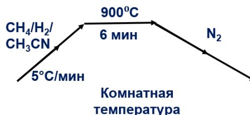
Рис. 7. Схема проведения CCVD-синтеза в условиях динамического температурного профиля. Скорость нагрева составляла 5^\circ C/мин . Продувка реактора азотом начиналась при 120^\circ C на стадии охлаждения.
