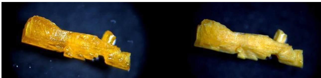
Рис. 122. Кристалл [\text{цис-Ca(OPPh}_3)_4(\text{H}_2\text{O})_2][\{\text{Mo}_6\text{Cl}_8\}\text{Cl}_6\} \cdot 2\text{CH}_3\text{CN}] до (слева) и после (справа) нагрева до 110^\circ\text{C}
