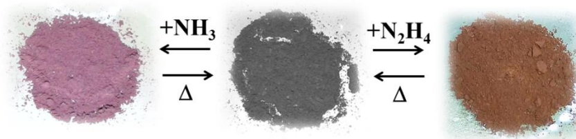
Рис. 64. Изменение цвета отожженного образца 17 при выдерживании в парах аммиака и гидразина.
