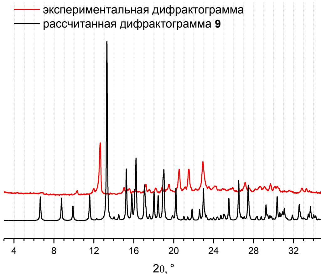
Рис. П16. Сравнение экспериментальной и рассчитанной дифрактограммы 9. Несовпадение положения рефлексов свидетельствует о разложении комплекса при извлечении кристаллов из маточного раствора.
