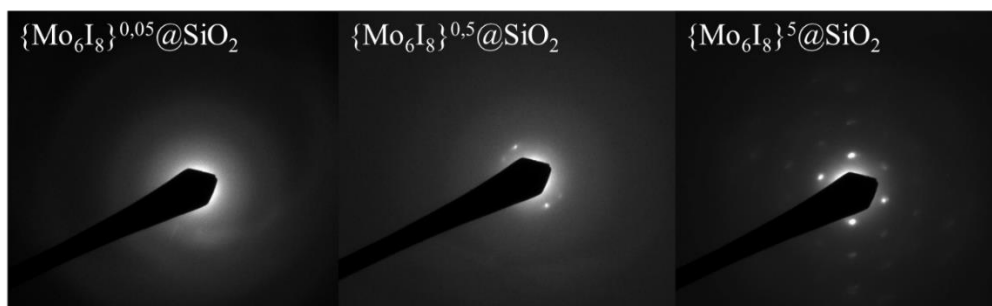
Рис. 221. Дифракция электронов в выбранной области для образцов \{\text{Mo}_6\text{I}_8\}^n @ \text{SiO}_2 ( n = 0,05, 0,5 и 5 )
