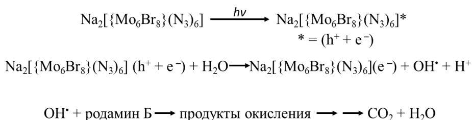
Рис. 29. Схема взаимодействия кластерного комплекса с родамином Б
