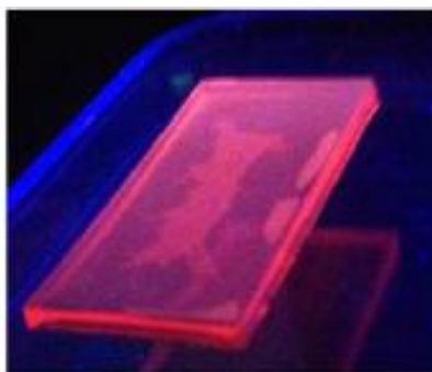
Рис. 25. Образец модифицированного полиуретана под ультрафиолетовым облучением
