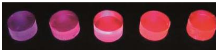
Рис. 22. Фотографии таблетированных образцов (\text{Bu}_4\text{N})_2[\{\text{Mo}_6\text{Br}_8\}\text{F}_6] @PMMA, с массовой концентрацией кластерного комплекса до 0,36 под ультрафиолетовым облучением
