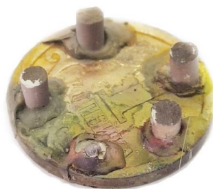
Рис. 16. Образцы монолитного сорбента, приклеенные на подложку и покрытые золотом толщиной пленки около 10 нм.
