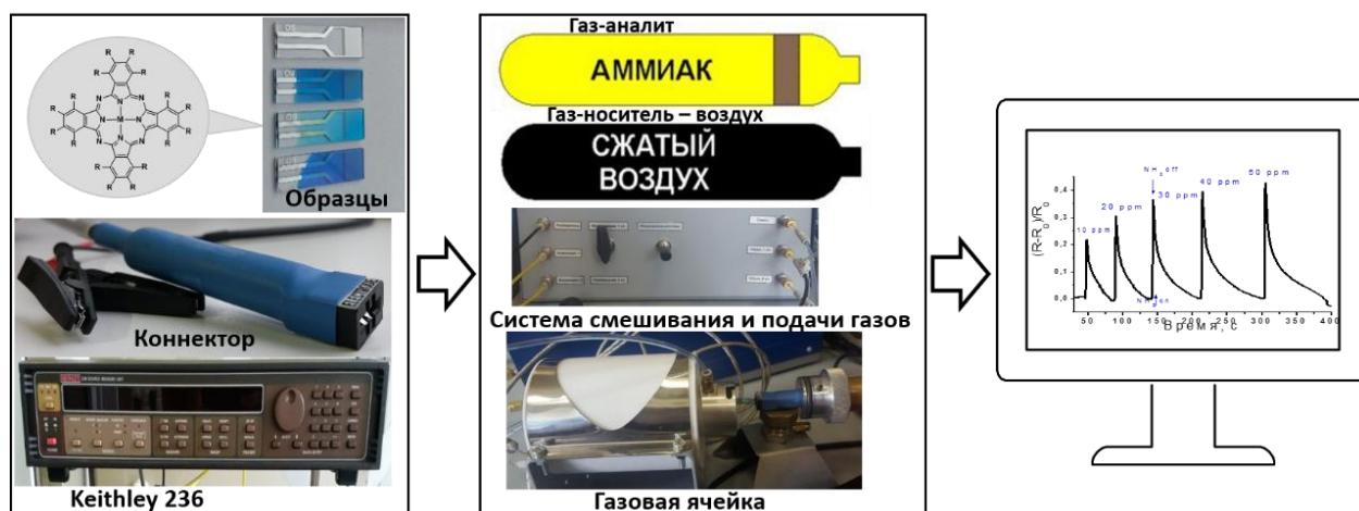
Рисунок 20. Схема установки для измерения сенсорного отклика пленок фталоцианинов металлов.
