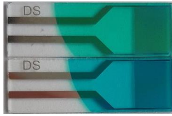
Рисунок 54. Изображение плёнок \text{VOPcF}_{16} до (сверху) и после (снизу) нагрева при температуре 200^\circ в течение 1 часа.
