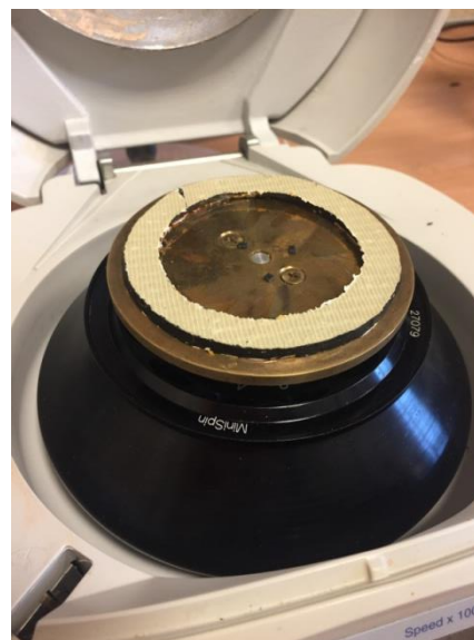
Рисунок п 5. Центрифуга «Mini-spin» с модифицированной насадкой и специальной камерой для изготовления подложек.
