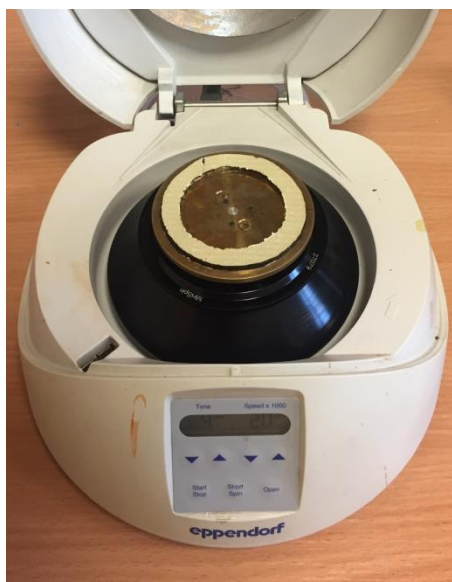
Рисунок п 5. Центрифуга «Mini-spin» с модифицированной насадкой и специальной камерой для изготовления подложек.
