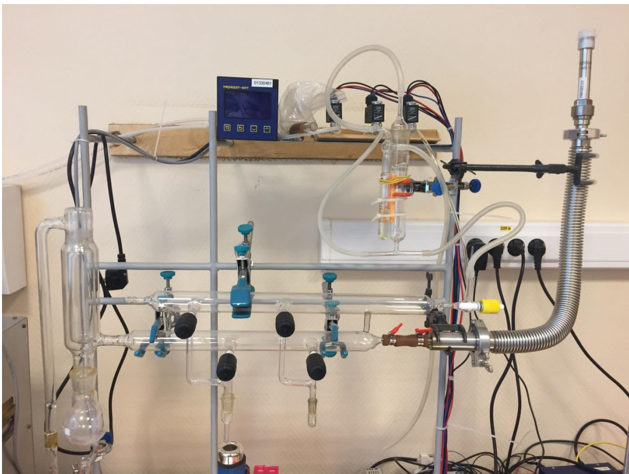
Рисунок п 2. Цельнопаянная газораспределительная система высокого вакуума для сушки электродов, подключенная к масляному диффузионному насосу.
