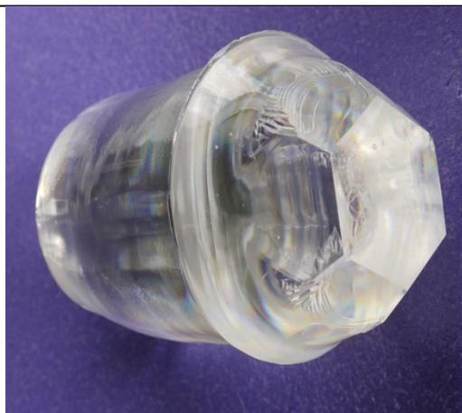
**Рис. 3.4.3.** Кристалл  $\text{Na}_2\text{Mo}_2\text{O}_7$ , выращенный в направлении  $[001]$ , на фронте грань пинакоида  $(001)$
