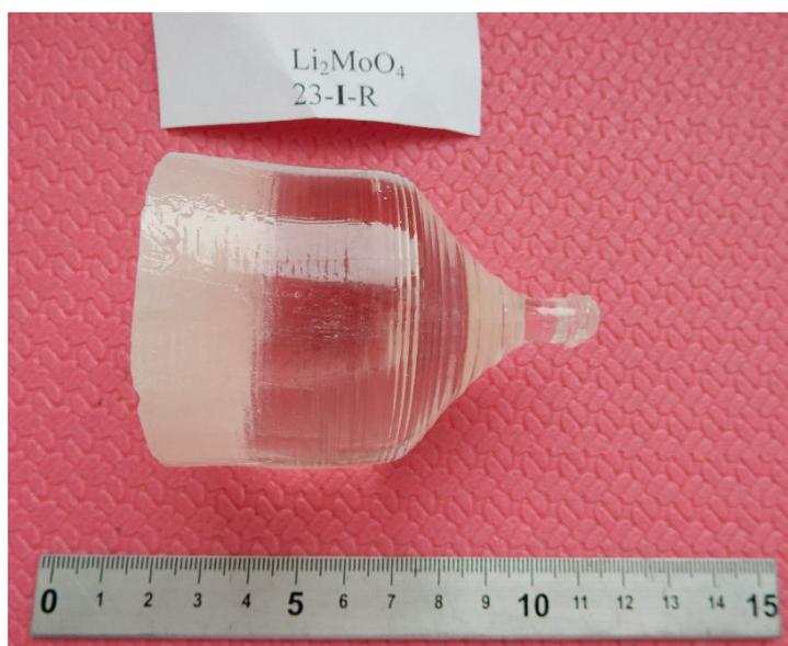
Рис. 3.1.1. Кристалл  $\text{Li}_2\text{MoO}_4$ , выращенный при скорости кристаллизации 1 мм/час.
