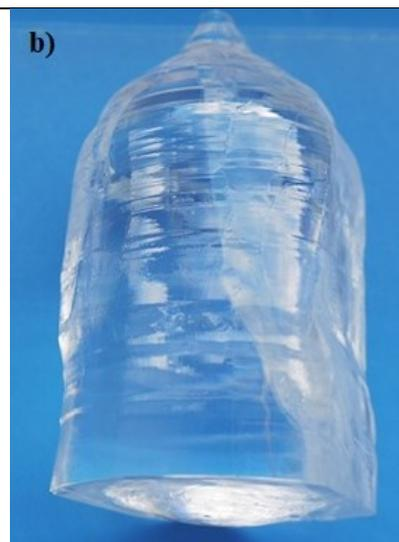
**Рис. 3.4.2.** Кристалл  $\text{Na}_2\text{Mo}_2\text{O}_7$ , выращенный в направлении  $[010]$  с округлым фронтом
