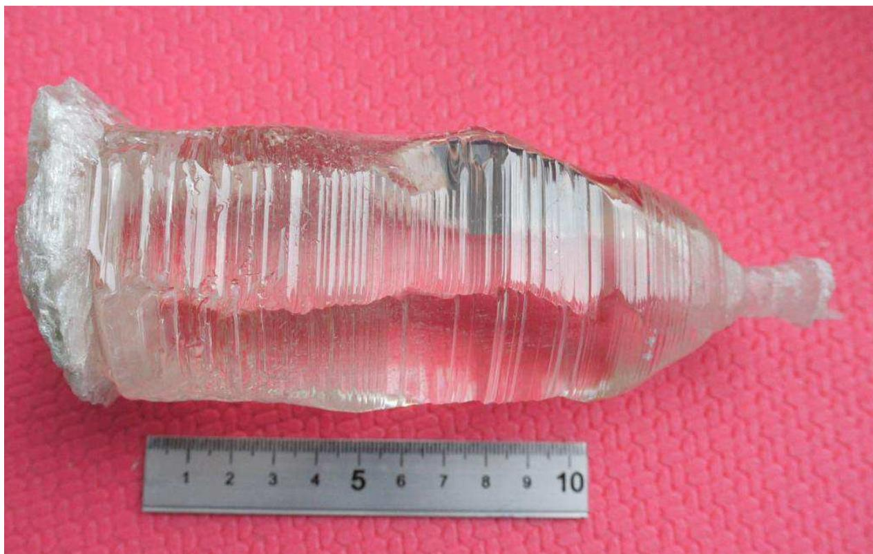
**Рис. 1.8.2.** Изотопно-обогащенный кристалл  $Zn^{100}MoO_4$  массой 1.4 кг, выращенный методом LTG Cz (ИНХ СО РАН) [74]
