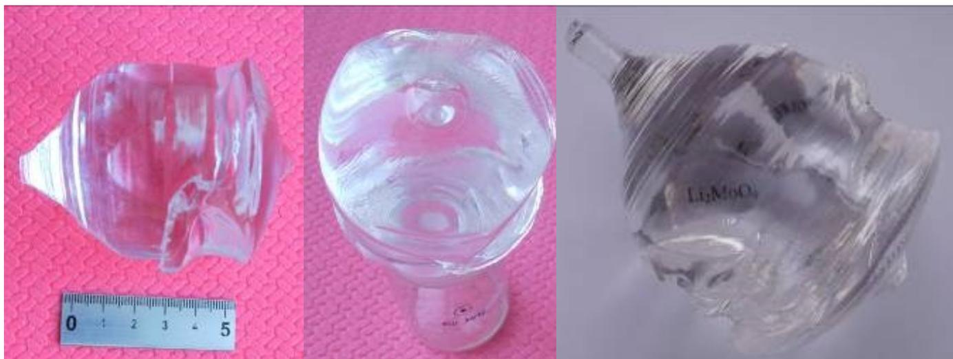
**Рис. 3.1.2.** Кристалл  $\text{Li}_2\text{MoO}_4$ , выращенный при скорости кристаллизации 0.5 мм/час.
