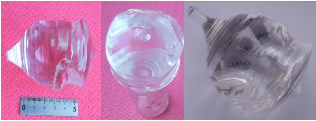
Рис. 2. Кристалл \text{Li}_2\text{MoO}_4 , выращенный при скорости кристаллизации 0.5 мм/час
