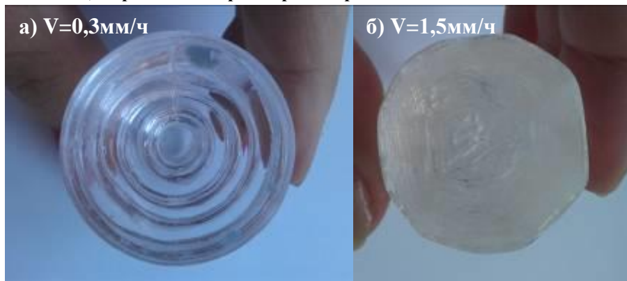
Рис. 3. Изменение формы фронта кристаллов \text{Li}_2\text{MoO}_4 при скорости роста: а) v=0.3 мм/ч, б) v=1.5 мм/ч
