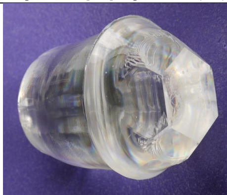
Рис. 9. Кристалл \text{Na}_2\text{Mo}_2\text{O}_7 , выращенный в направлении [001]
