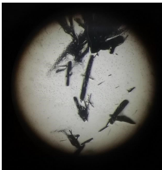
Рис.29. Внешний вид кристаллов (\text{Bu}_4\text{N})_4[\text{Ta}_6\text{I}_{12}(\text{CN})_6] \cdot \text{CH}_3\text{CN} .
