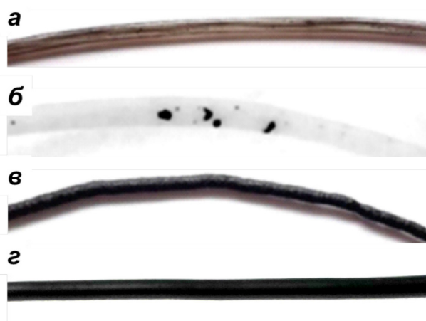
Рисунок 10 – Фотографии полимерных нитей с 0,1 масс.% ОУНТ, изготовленных из (а) опудренных гранул полистирола, (б) смесь полистирола и 10% мастербатча ОУНТ, (в) прутка на основе мастербатча (многократная повторная экструзия), (г) измельченного полимерного композиционного материала.
