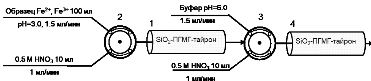
Рисунок 6.27. Схема разделения и определения Fe(III) и Fe(II) с использованием двухколоночного варианта: колонка (1, 4), кран (2, 3)
