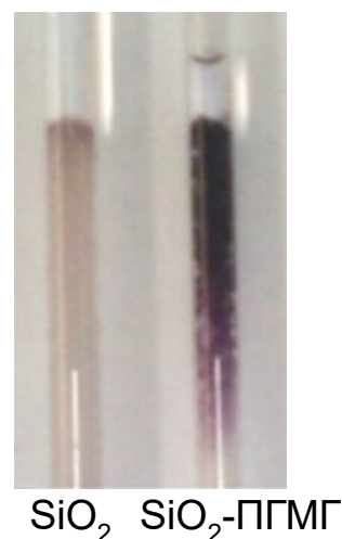
Рисунок 3.2. Фотографии капилляров, заполненных \text{SiO}_2 и \text{SiO}_2 -ПГМГ, после обработки раствором Арсеназо I
