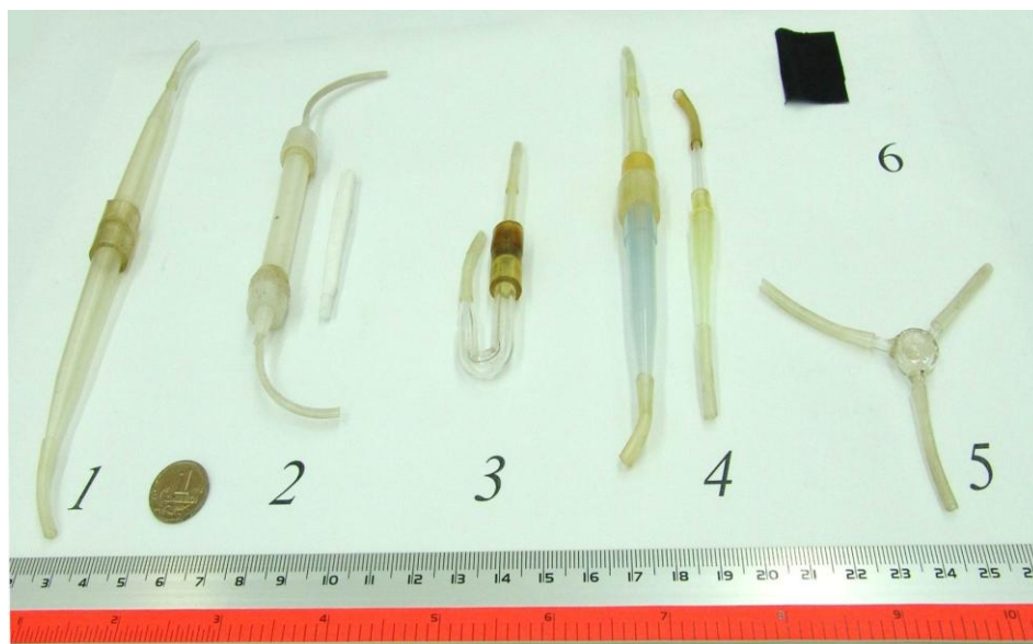
Рис. 7. Фото реакторов, смесителя и вкладыша одноразового использования проточного стехиографа: 1-4 – реакторы различного объема и вкладыши, 5 – стеклянный смеситель потоков компонентов растворителя, 6 – липкий вкладыш с нанесенной на его поверхность навеской пробы
