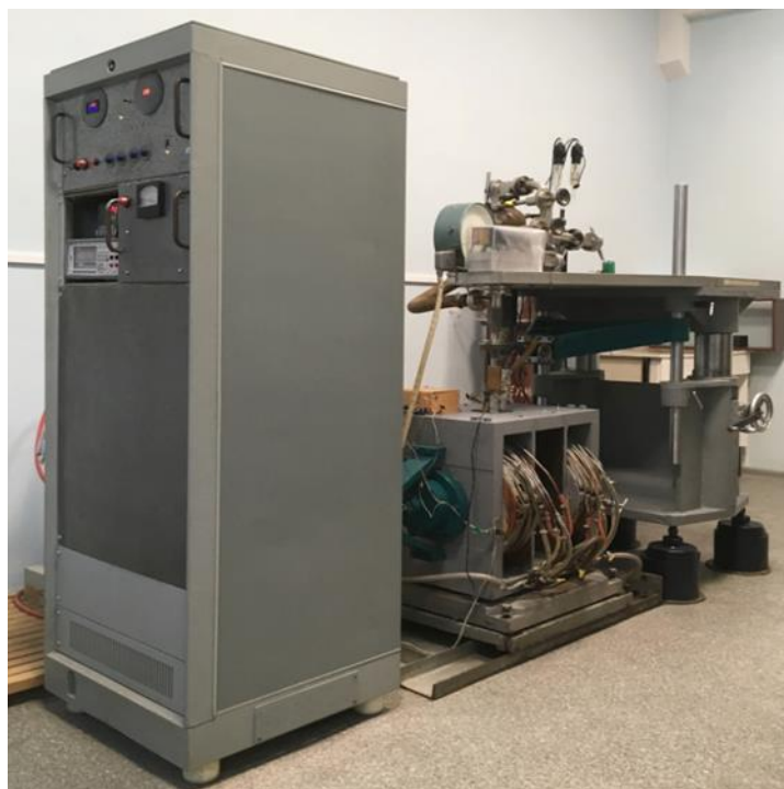
Рис. 12. Фотография установки «Весы Фарадея» для измерения магнитной восприимчивости.
