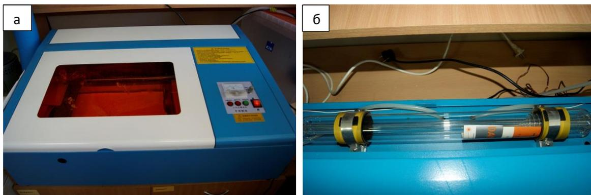
**Рис. 8.** Фотография установки лазерного профилирования (а), используемая в установке CO<sub>2</sub> лазерная трубка (б).
