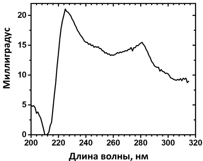
Рис. П28. Спектр кругового дихроизма комплекса  $[\text{Re}_6\text{S}_8(\text{CN})_6]^{4-}$  в присутствии избытка  $\gamma$ -циклодекстрина.
