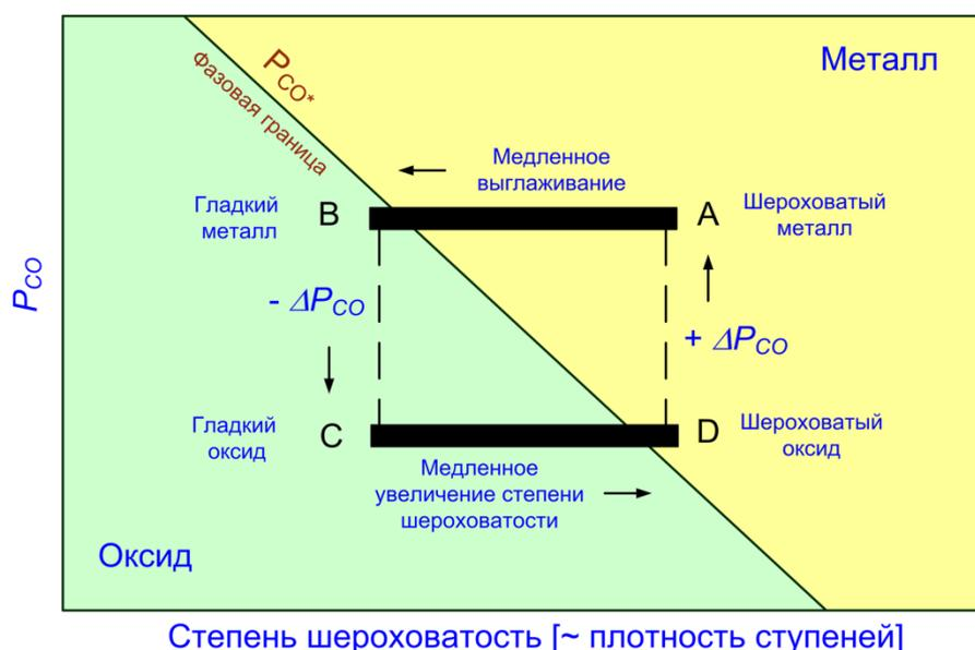
Рис. 5. Модель автоколебаний при окислении CO на монокристалле Pd(001), предложенная в работе [96]
