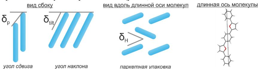
Рис. 2. Схематическое изображение углов и длинной оси молекулы в кристаллах линейных молекул
