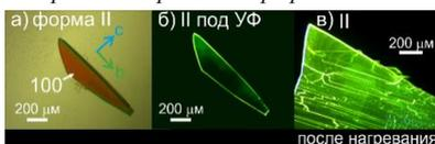
**Рис. 12.** Монокристаллы **формы II** в проходящем свете (а), при УФ-облучении (б), после нагревания (в)
