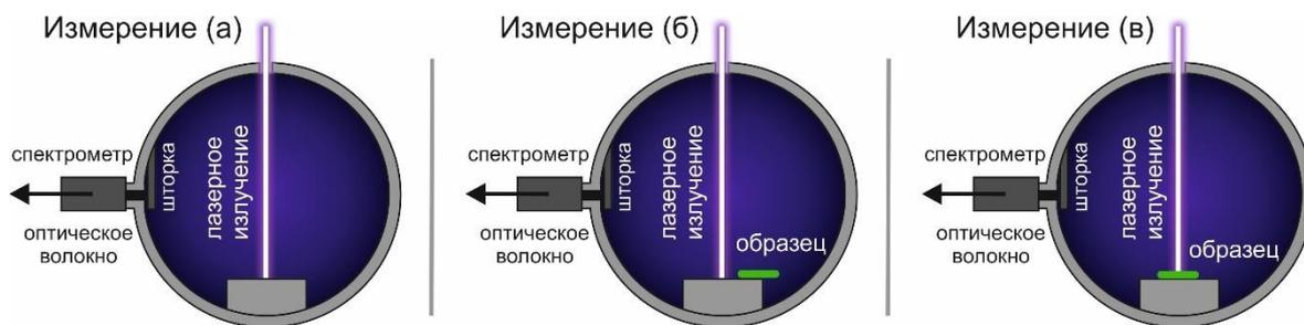
**Рис. 21.** Измерения, необходимые для вычисления квантового выхода фотолуминесценции кристалла в интегрирующей сфере
